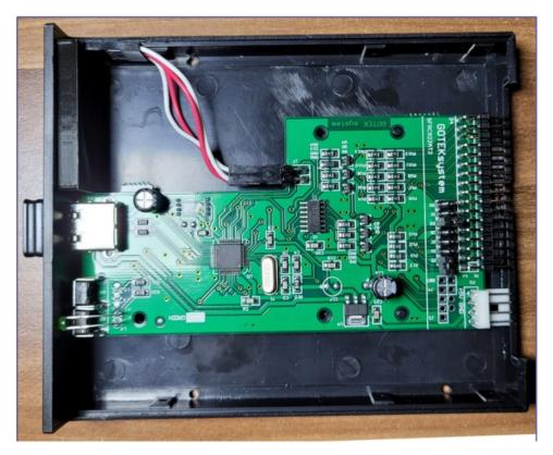
Vor Abziehen des Display-Anschlusses (zu sehen in Bildmitte), auf die Farbfolge der oberen beiden Drähte achten. Die hier im Bild müssen nicht identisch zum geöffneten Gerät sein! Der Stecker muß anschließend in gleicher Weise wieder aufgesteckt werden (eigentlich logisch ;-) ). Nach einlöten des
