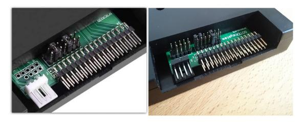
Wie auf beiden Fotos zu erkennen, muß bei dem 2x5 Pin-Header der ganz linke Pin der vordersten Reihe entfernt werden. Das ist einfach mit einer Spitzzange durch herausziehen zu erledigen. Vorm Einlöten müssen die drei Kreuzschlitzschrauben, auf der Gehäuseoberseite, durch die drei Löcer leicht zu finden, herausgedreht werden. Den Deckel dann abheben und die PCB nach abziehen des 4-poligen Steckers für's LED-Display herausnehmen. Hier ein Foto mit entferntem Deckel und Blick auf's Innenleben:
