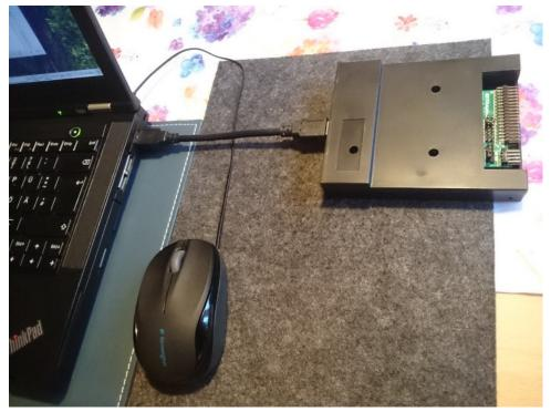
Das LED-Display bleibt im Programmiermodus dunkel! Das Laufwerk kann die Version der Firmware anzeigen, wenn der rechte der beiden Druckknöpfe betätigt wird. Damit das klappt, darf das Laufwerk nicht im Programmier-Modus sein. Die Versionsnummer wird in zwei Schritten auf den rechten beiden LED-Ziffern angezeigt, erst die Ziffer vor dem Komma, dann die beiden nach dem Komma. Als neue Firmware habe ich FlashFloppy V3.30 bzw. V3.35 eingespielt, zu finden auf Github unter:
