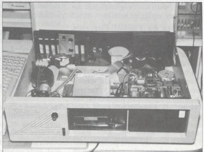
Bild 3: Die Floppy-Erweiterung, hier im Ausbau als selbständige Einheit
